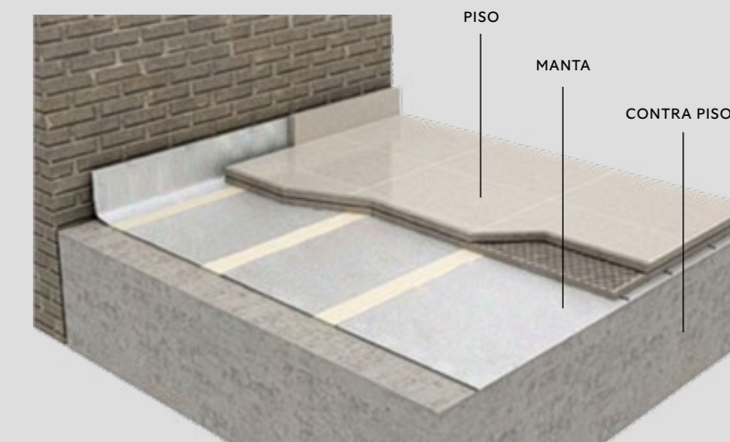
Manta acústica na laje
